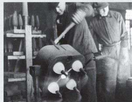
▲ Выбика отливок 82-мм мин из кокилей в литейном цехе
